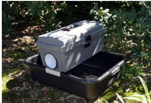
Figura 5: trappola Gravid assemblata e posizionata.
